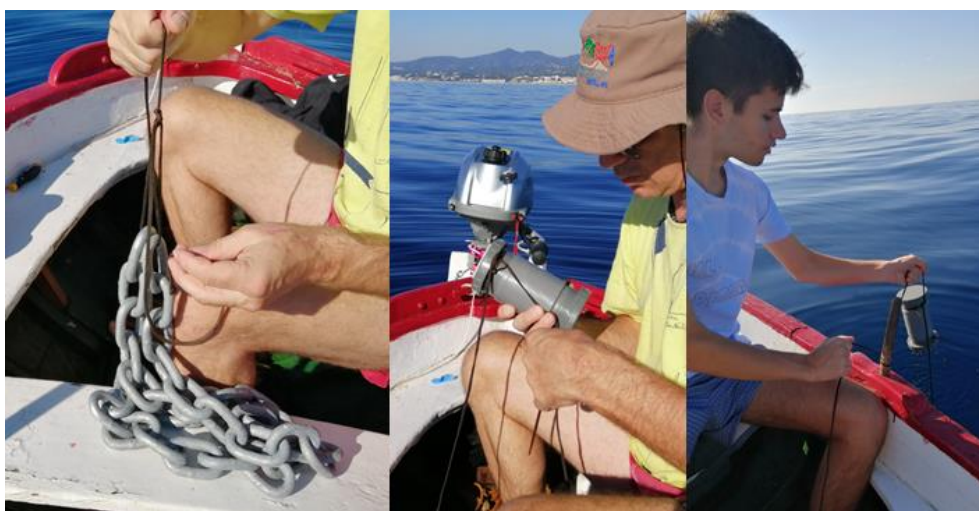
Preparació de la mesura: lligar el pes, enbridar l'instrument i posar-lo a l'aigua per anar mesurant en la baixada.
