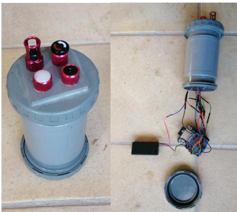
Equip batitermògraf amb l'electrònica connectada i muntat dins el tub de PVC.
