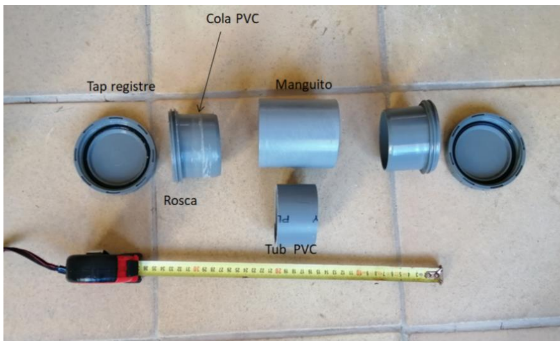
Peces del tub estanc de PVC: 2 taps de registre D75 amb la seva rosca, un manguito D75, i un tros d'uns 3cm de tub D75
