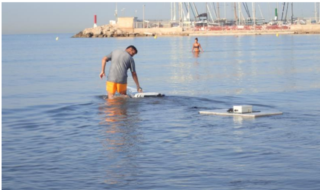
Equip muntat sobre una taula de porexpan i remolcat des d'una taula de surf
