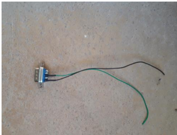
Connector dB9 mascle amb els cables Tx i Rx soldats
